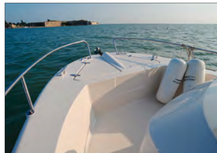
Le pont avant, de type walkaround, est de plain-pied avec le cockpit. La largeur importante des plats-bords permet de s'en servir d'assises à l'heure du casse-croûte.
