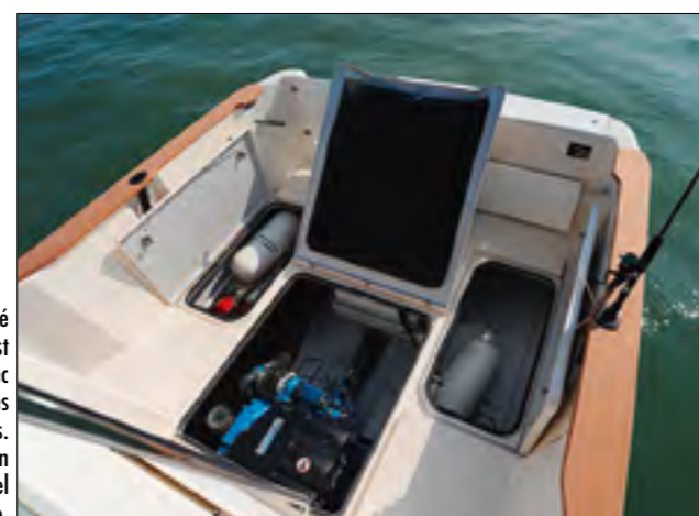
La capacité de rangement est importante avec deux grandes soutes latérales. La motorisation H4.150 Nanni diesel est bien accessible.
