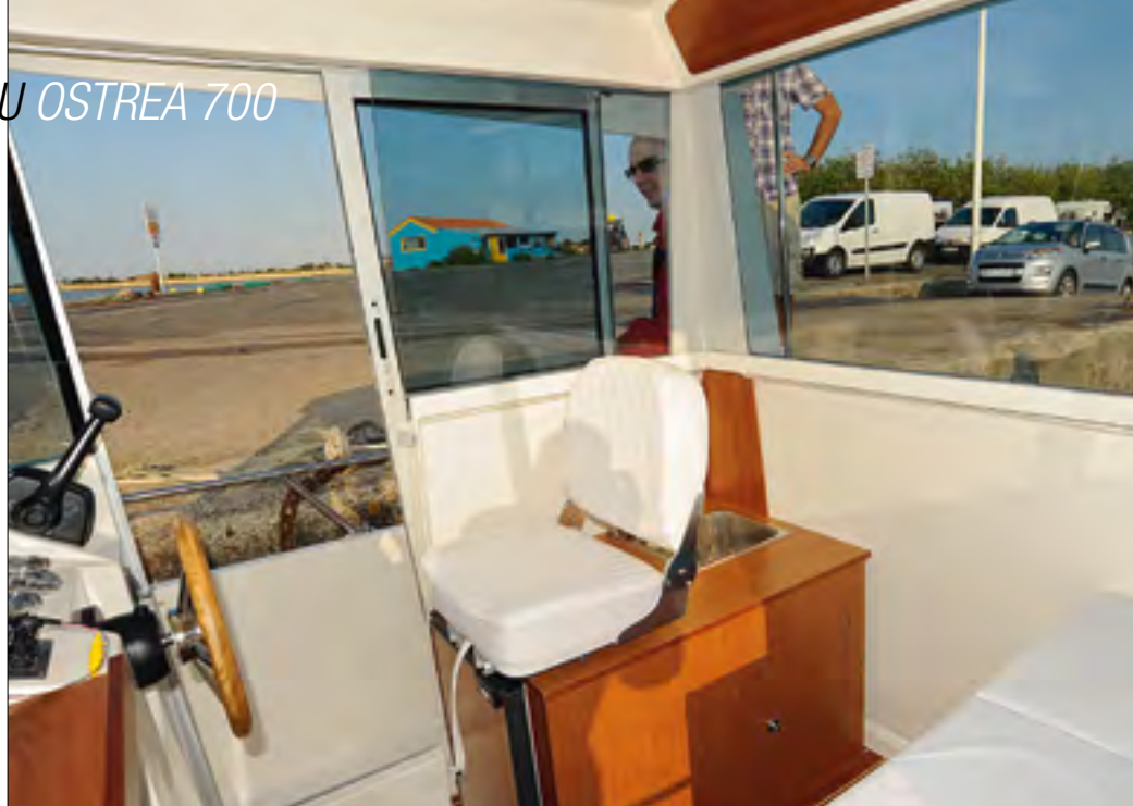
L'aménagement de la timonerie comprend un bloc kitchenette et une banquette double surmontant un meuble de rangement.
