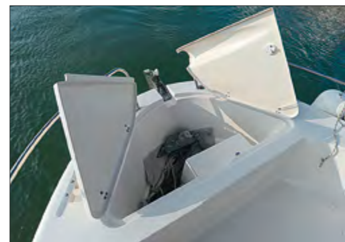
La baïlle contre-moulée montre de belles dimensions. Elle dispose d'un anneau d'étalingure et d'un support pour le guindeau électrique.
