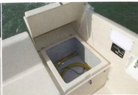
Le coffre qui complète la banquette a pour vocation de servir de vivier, bien vu !
