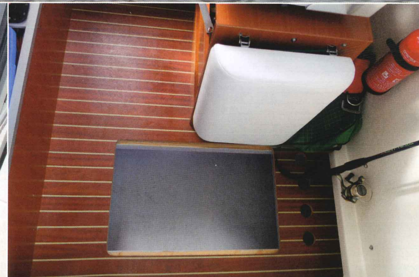
Le plancher de la timonerie dispose d'un vaste coffre. Les orifices qui complètent de système de rangement des cannes à pêche permettent de prendre soin des cannes en carbone notamment.
