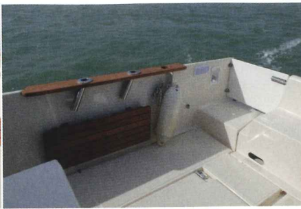
Les pavois intègrent des banquettes escamotables en option et deux porte-cannes sur les plats-bords.
