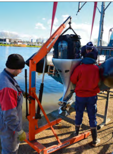
Modifier la hauteur de montage d'un V6 avec une simple chèvre, c'est possible !
