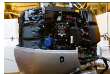
Ce bloc affiche une cylindrée de seulement 2 354 cm 3 , la plus petite du comparatif.
