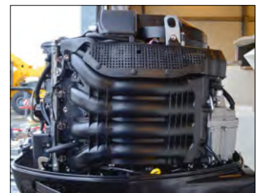
Contrairement au Suzuki 150 AP, le 150 T ne dispose pas de la technologie Lean Burn.
