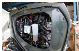
Il est possible de contrôler le niveau et la qualité de l'huile d'embase grâce à un réservoir transparent.
