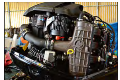
Le compresseur et le régulateur électronique de suralimentation sont au premier plan.
