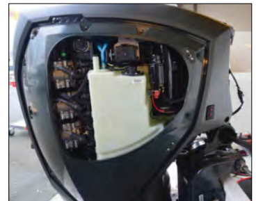
Le réservoir d'huile d'une contenance de 11,4 litres est intégré sous le capot moteur.
