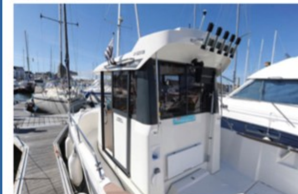
La timonerie est pourvue d'une vitre coulissante sur l'arrière, mais une porte est disponible en option.
